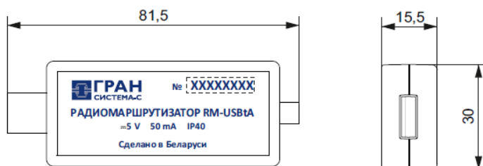
Рисунок Б.4 – Внешний вид, габаритные и установочные размеры радиомаршрутизаторов RM-USBXX
