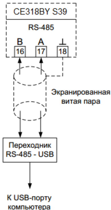
Рисунок 8. Схема подключения интерфейса RS-485 счетчика CE318 S39
