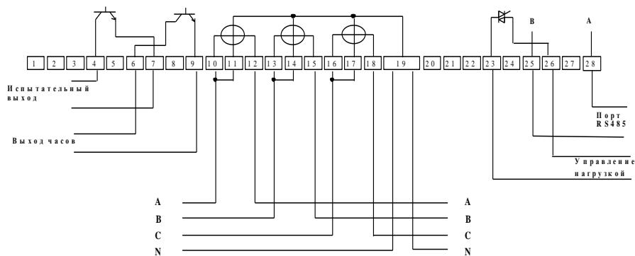
Рисунок В.1 – Схема подключения счетчика непосредственного включения
