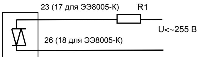
R1 – сопротивление нагрузки (катушка исполнительного реле)
